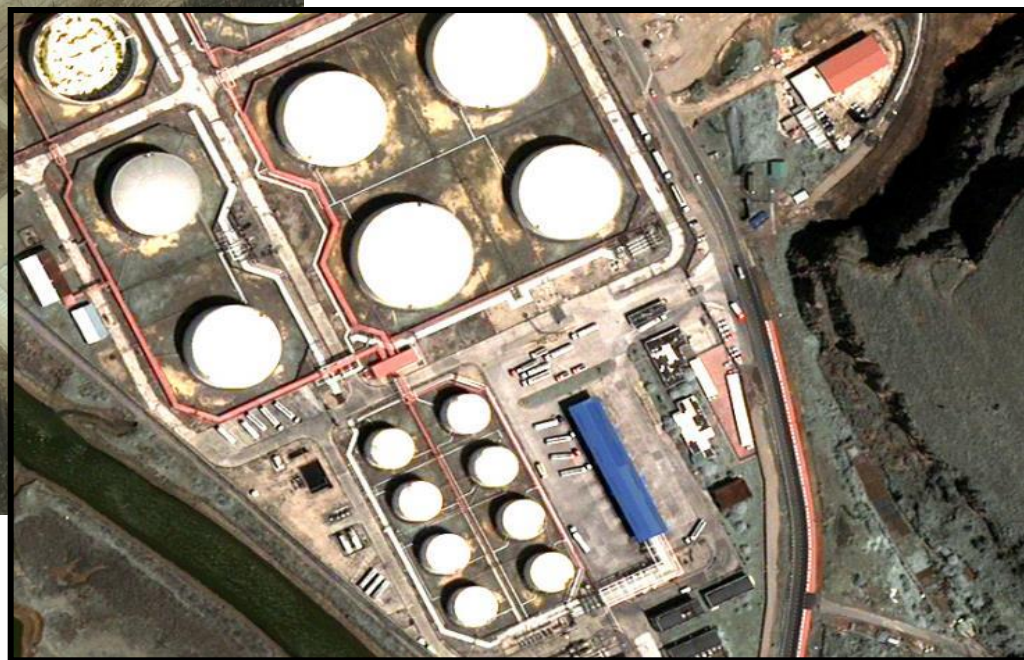
Фрагмент снимка QuickBird 0,61 м Нефтехранилище с емкостями для хранения нефтепродуктов и загрузочным терминалом
